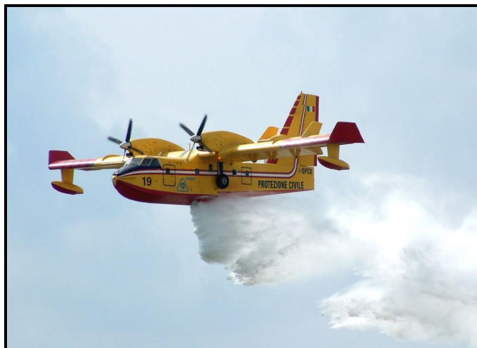
Fig. 22 Bombardier CL-415 descarregant l'aigua emmagatzemada
