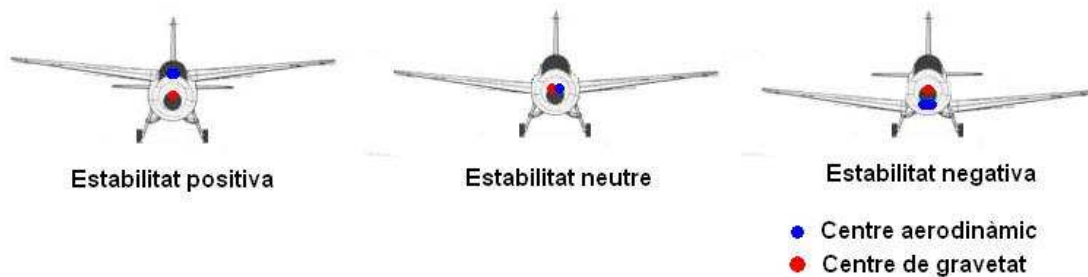
Figura a.7.7. Diferents tipus d'estabilitat lateral. Font: elaboració pròpia
