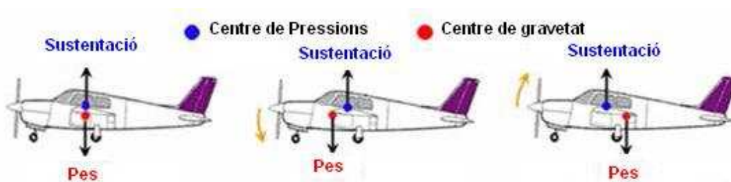
Figura 5.2.9.1: Tipus de estabilitat longitudinal. Font: Pérez & Sintés (2007).
