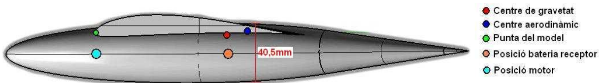
Figura 5.2.11.6. fuselatge que s'afegirà al model a dissenyar per englobar els components. Font: elaboració pròpia
