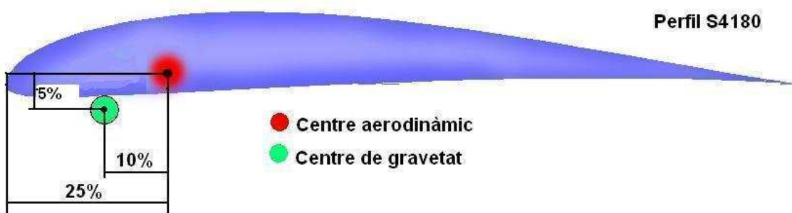
Figura 5.2.9.3. Perfil del model amb el centre aerodinàmic i de gravetat aplicats. Font: elaboració pròpia
