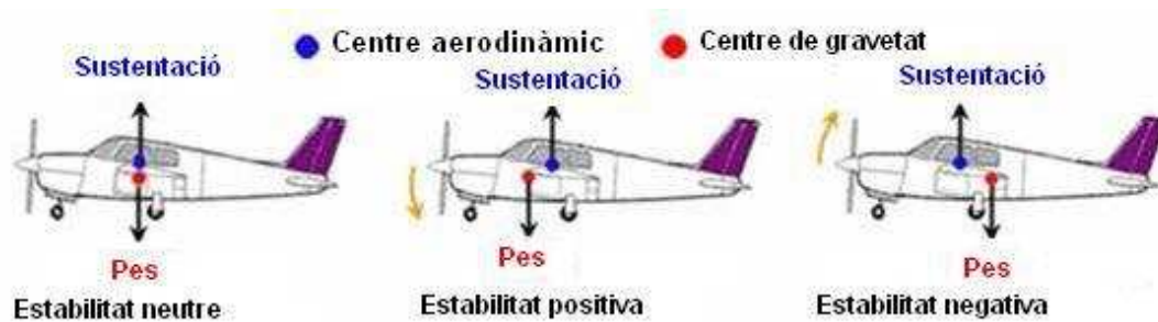
Figura a.7.1: Tipus de estabilitat longitudinal. Font: Pérez & Sintès (2007).
