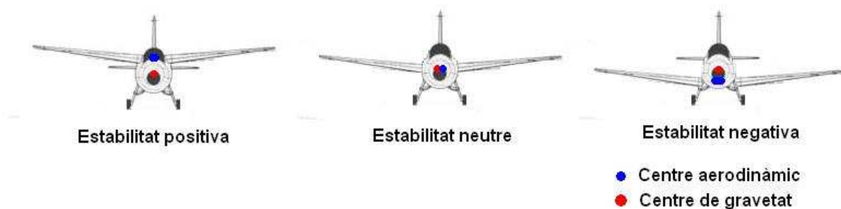
Figura 5.2.9.2. Diferents tipus d'estabilitat lateral. Font: elaboració pròpia
