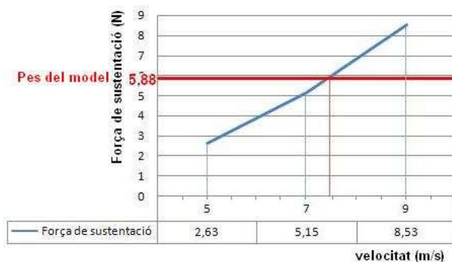
Figura 6.3.9. Gràfica de força de sustentació i velocitat del model. Font: elaboració pròpia
