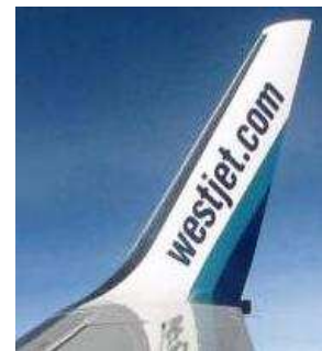
Figura 5.2.5.1. Winglet d'un avió de passatgers. Font: http://images.google.es/
