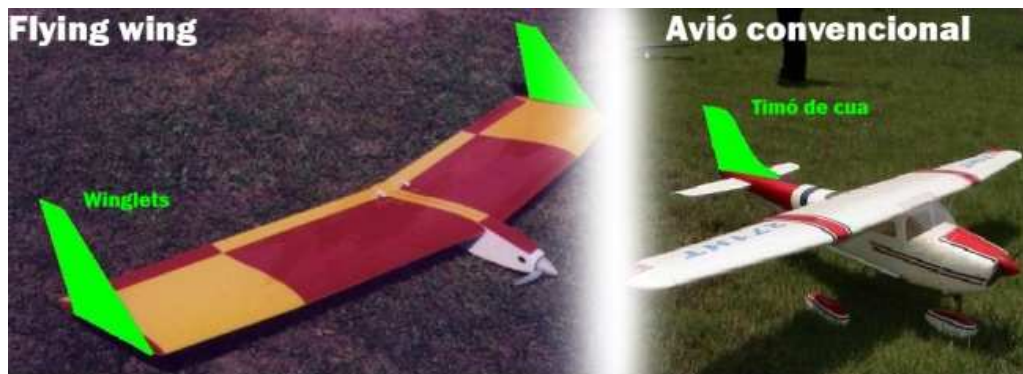
Figura 5.2.5.5. Comparació funcional dels winglets i el timó de cua en un avió convencional i en un flying wing . Font: elaboració pròpia
